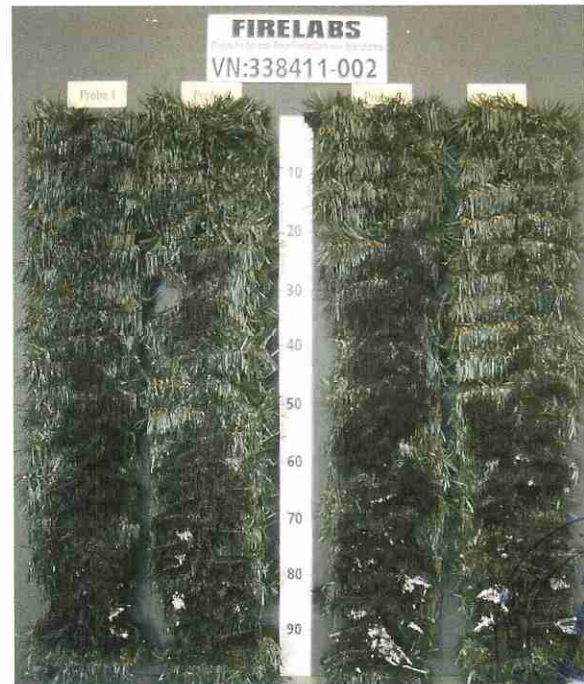
Bild 4 Aussehen des Probekörpers nach dem Brandversuch
