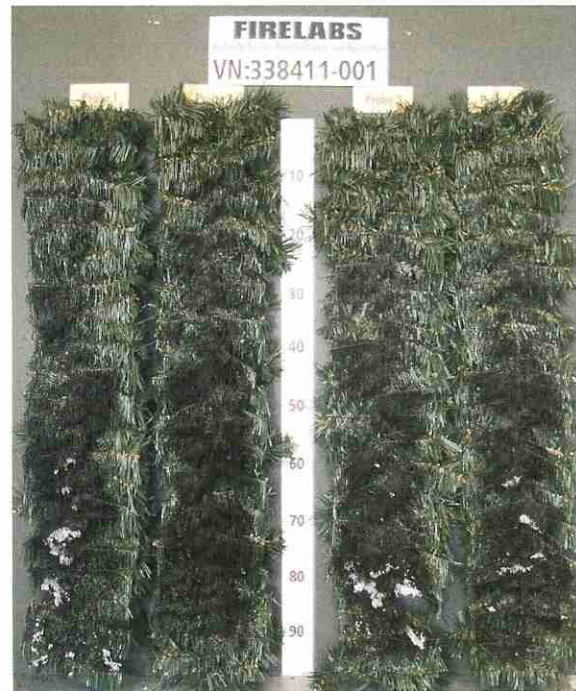
Bild 2 Aussehen des Probekörpers nach dem Brandversuch
