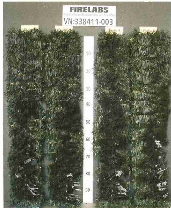
Bild 6 Aussehen des Probekörpers nach dem Brandversuch
